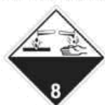
N°8 Matière corrosive
