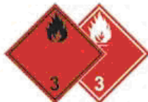
N°3 Danger de feu (matière liquide inflammable)
